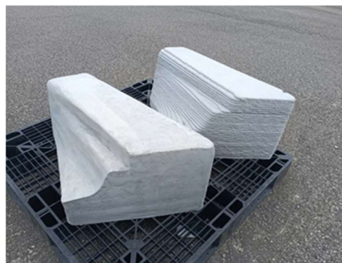
Polyuse Zero による形成物（手前：表面ならし有り、後方：ならし無し）ならし有りの外観は通常品と比べても遜色ない
